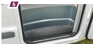
Eine **eingebaute isolierte Aufbaustufe**.
