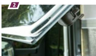
**Doppelverglaste Fenster** mit festem, elegantem Polyurethanrahmen mit Verdunklungsrollo (mit Aluminiumbeschichtung) und Moskitonetz.
