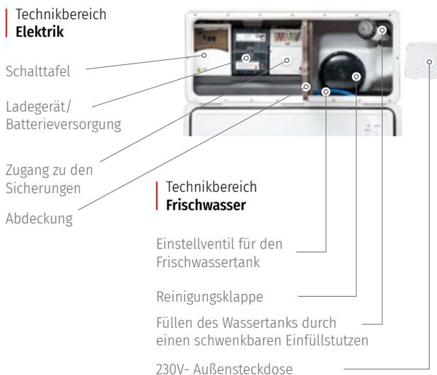
➔ **Der Technikbereich Elektrik** bietet leichten Zugang zur Schalttafel: keine Verrenkungen mehr, um eine Sicherung zu wechseln!
