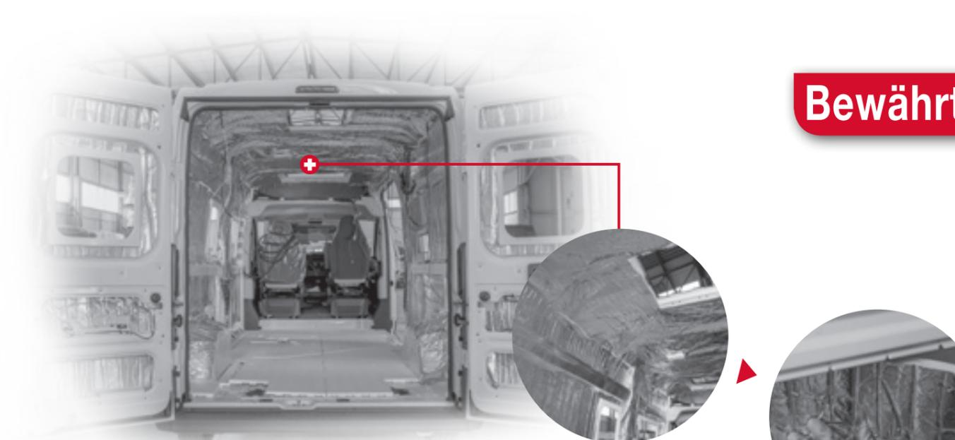
Geräuschttest bei äußeren Lärmquellen (durch den Einsatz von Schallpegelmessern, die von der italienischen Eichstelle SIT geeicht und zertifiziert wurden), haben gezeigt, dass der im Innenraum des Vans wahrgenommene Geräuschwert bei Regen im Wohnbereich um 37% und im Heckbereich um -30% verringert wird.
