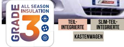
Die Norm EN1646-1 ist verbindlich: Um die höchste Stufe (Grade 3) zu erreichen, muss die Innentemperatur bei einer Außentemperatur von -15°C in weniger als 4 Stunden auf +20°C ansteigen.
